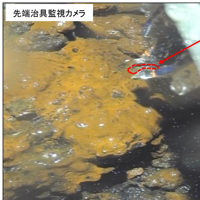
開口底部で燃料デブリを把持した状態
