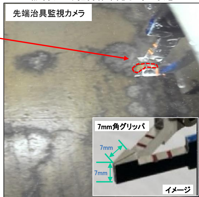
燃料デブリ把持作業完了時の状態
