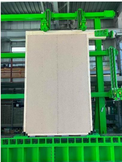
耐力壁の性能比較実験（G-BOARD と TN 釘の耐力壁試験）
