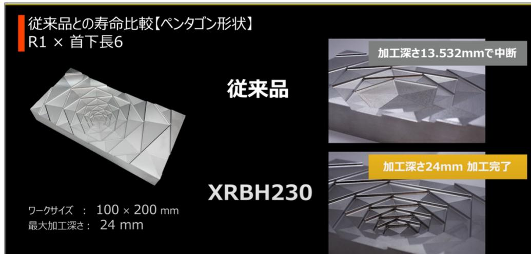
←従来品では工具摩耗が大きく、加工を中断
