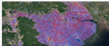
Flood Damage Assessment／洪水被害分析 洪水などの浸水被害（浸水域、浸水深、被害道路、被害建物）評価サービス。保険のための損害査定やレスキュー活動のための迅速な調査などに活用
