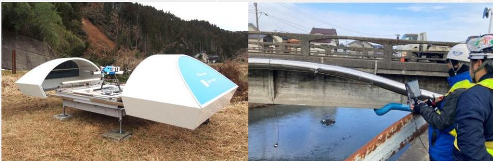
ドローンポートから自動かつ定期的に発着するドローンにより、地震の影響で河川に出来た土砂ダムの状況を継続的に監視
