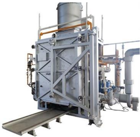
省エネルギー型熱処理・工業炉 (プロトタイプ、有効容積1.3m 3 )
